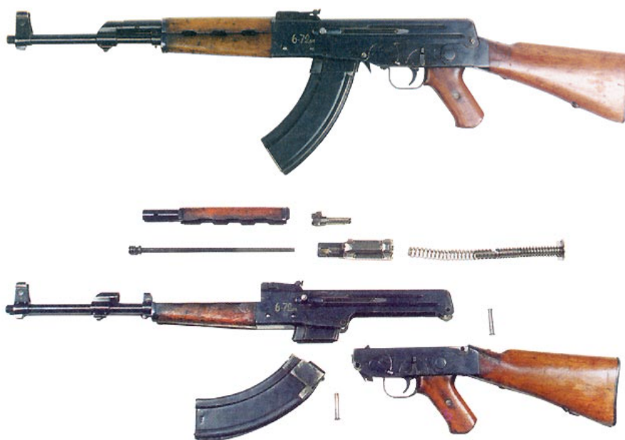
первый опытный автомат Калашникова под патрон 7.62x41, 1946 год, также известный как АК-46
