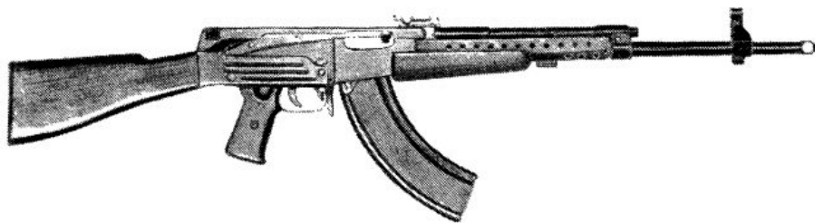
Первый советский автомат под промежуточный патрон образца 1943 года (7.62x41) – автомат Судаева АС-44, проходивший войсковые испытания весной-летом 1945 года.
